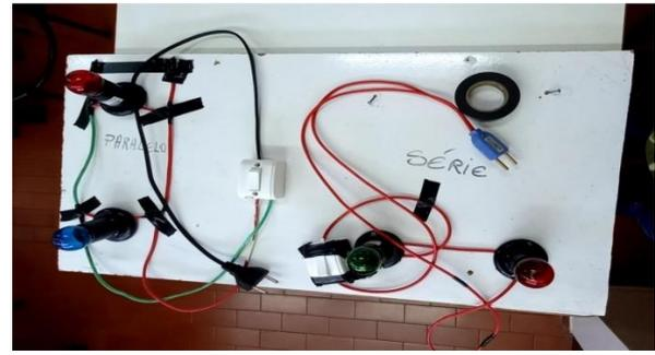
Fig. 02: Experimento Corrente Elétrica
